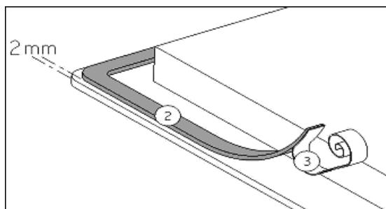
Do vyříznutého otvoru v pracovní desce vložte varnou desku.
